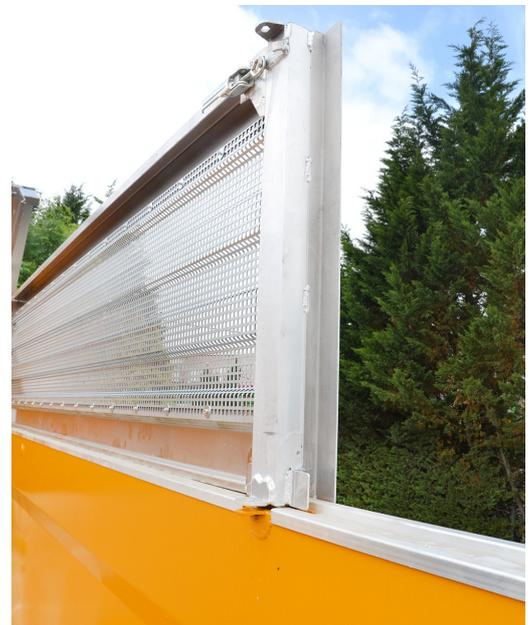
Die sechs Elemente sind auf der ganzen Länge des Kastenrahmens auf Schienen montiert. Die Aufsätze sind durch mehrere Verschlussgriffe an den Mittelpfosten befestigt, welche für die Festigkeit des gesamten Aufbaus sorgen.
